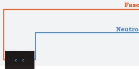
Per installare il nostro impianto si possono sfruttare le comuni scatole di derivazione a tre posti (c.d. modello 503). Gli attuatori sono suddivisibili in due categorie: **Master** e **Satellite**.
